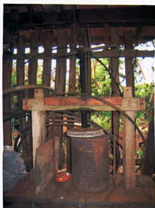
Prensa para fabricar farinha de mandioca - Martinésia
