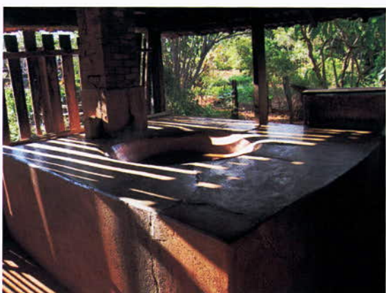
Fornalha para fabricar farinha de mandioca - Martinésia
