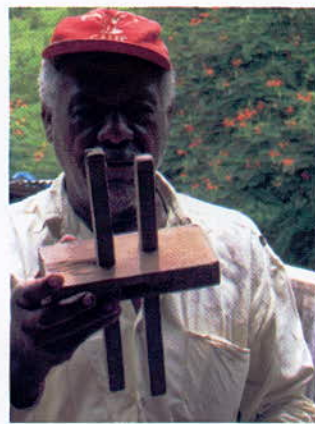
Gramim - Instrumento de medição para fazer porteira Fazenda Buracão Tenda do Moreno
