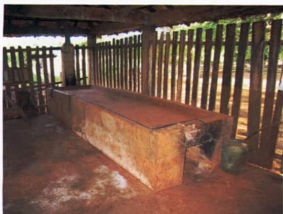
Forno para secar farinha de mandioca - Martinésia
