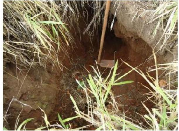
**Figura 10.4.k – Detalhe do processo de pipping que desemboca no perfil de exposição.**
