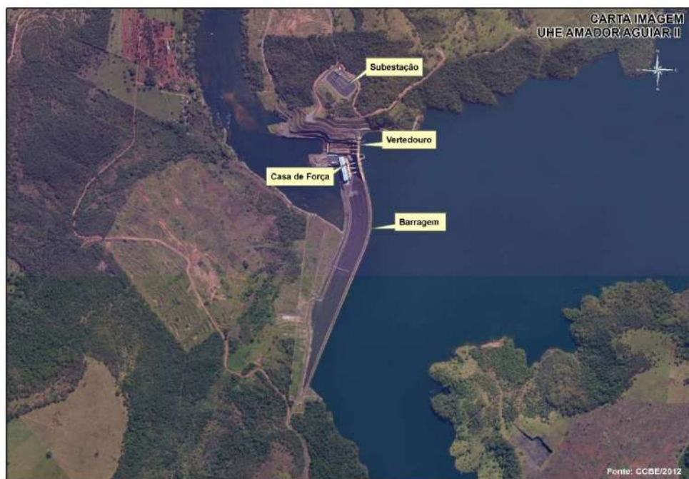
Figura 1 – Arranjo Geral da UHE Amador Aguiar II.
