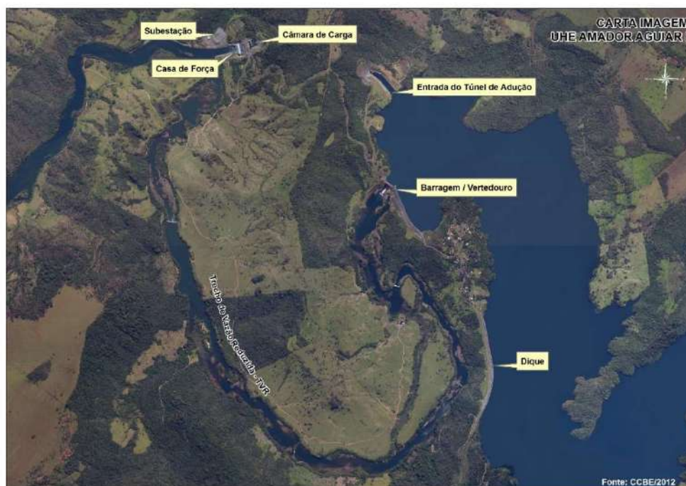
Figura 01– Arranjo Geral da UHE Amador Aguiar I
